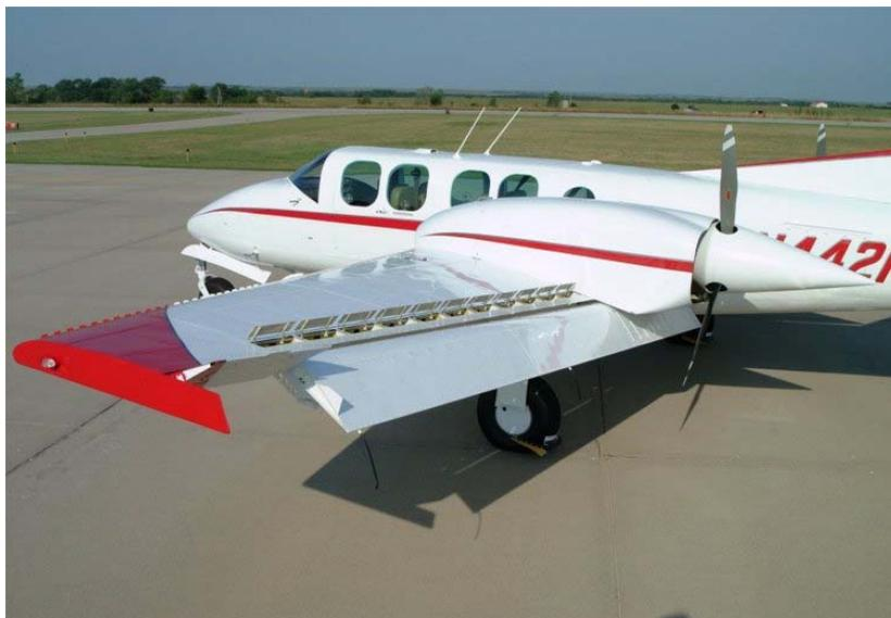
대형 제트기에 있어서 고속 비행 중에 좌우 날개에 대칭적으로 스포일러를 펼치면 에어 브레이크의 기능을 가지게 되고, 보조 날개와 연동하여 좌우 비대칭적인 작동을 시키면 보조 날개의 역할을 보조하는 기능이 된다. 이를 공중 스포일러라고 한다. 그리고 착륙 접지 후에 작동시켜 양력을 감소시킴으로써 바퀴의 제동력을 향상시키고 항력을 증가시키기 위하여 사용하는 스포일러를 지상스포일러라고 한다.
